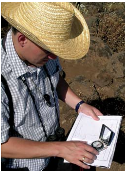
13. kép: A lejtő kitértségének (fekvésének) rögzítése. (© University of Pavia)
